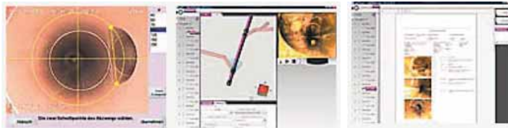
Dimensionsbestimmung von Abzweigen, Navigieren durch das 3D-Rohrleitungssystem sowie ein Echtzeit-Video des zu der Leitung gehörenden Inspektionsvideos
